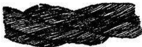
Рисунок 1. Обрывы и смещения проволок каната крестовой свивки.
