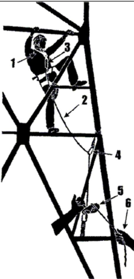
Работник обязан осуществлять организацию временных анкерных точек с фактором падения не более 1 (схема 1 приложения N 8), при перемещении по конструкциям и высотным объектам с обеспечением своей безопасности вторым работником (страхующим).
